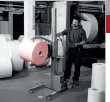
Hebezeug mit elektrischer Greif- und Drehfunktion.
