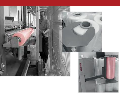
Reel Handler und Wave für einfaches, effektives Handhaben von Verpackungsbzw. Oberfolie.
