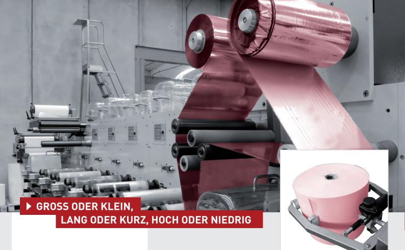
Heben und transportieren Sie Rollen mit Hebeliften von Hovmand.
