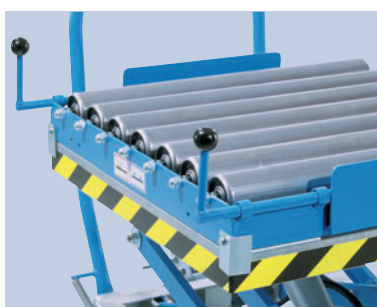
| Rollenbahn mit handbetätigter Schwerkraftklinke
